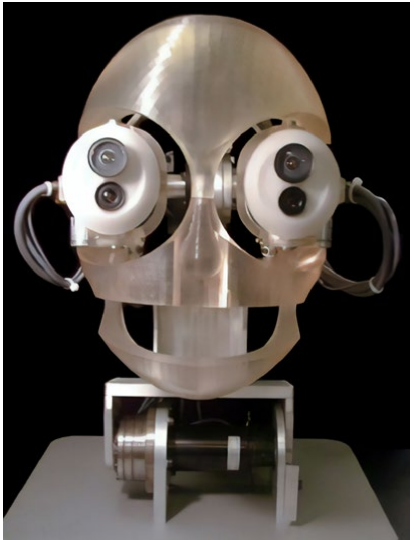
Abb. 5: Lazlo , ein humanoider Roboter, der um das Jahr 2000 am MIT entwickelt wurde, sollte ursprünglich das Gesicht eines anderen Roboters namens Cog erhalten. Obwohl Lazlo ziemlich abstrakt gestaltet ist, wirkt sein schädelartiges Gesicht mit zwei Kameras in jeder Augenhöhle unheimlich. Selbst Roboter, die gezielt weniger menschlich entwickelt wurden, um das unheimliche Tal zu vermeiden, erliegen oft diesem Effekt. Weitere Beispiele sind CB2 und Telenoid der Universität Osaka und Kaspar der Universität Hertfordshire. Fotonachweis: Aaron Edsinger, MIT
